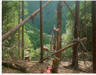
②恐ろしいくらいの荷重がかかる本線を1本の立木と控えのワイヤーで支える。
